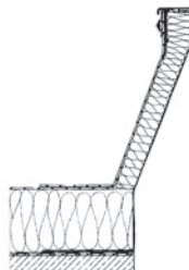
Metall-Aufsetzkranz Typ TE, 40 cm hoch mit E-Klemmschiene
