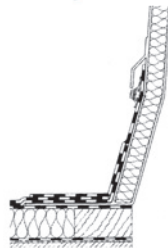
GFK-RAK für RWA mit optionaler GFK-Schürze (Überhangstreifen)
